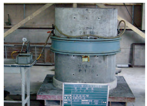
接合部の水密性試験状況
