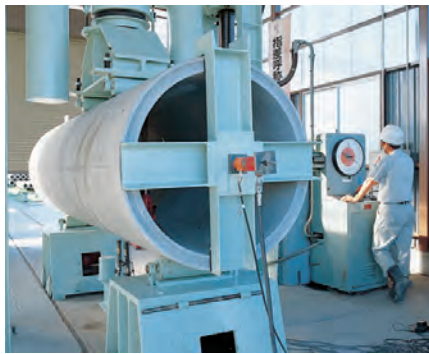
軸力曲げ試験状況
