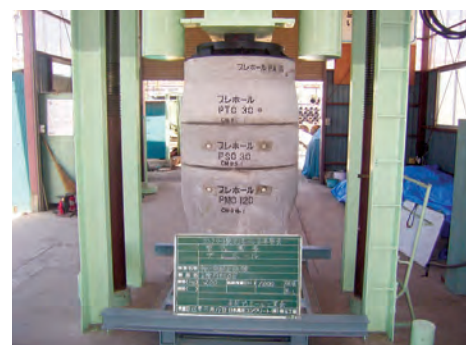
軸方向耐圧試験状況
