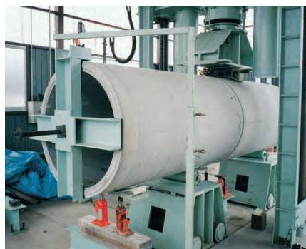
せん断試験状況
