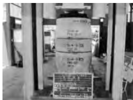
写真4-1 軸方向耐圧試験状況
