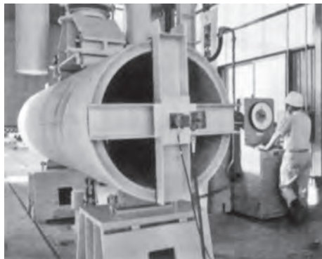
写真4-4 軸力曲げ試験状況
