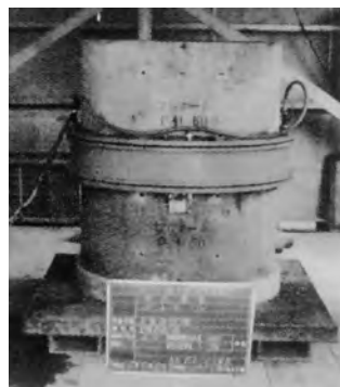
写真4-2 接合部の水密性試験状況
