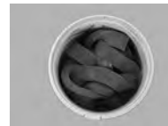
③ プレクイックにスポンジを入れ揉むようにして全量含浸させる
