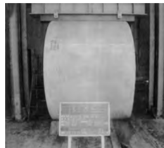
写真4-3 側方曲げ強さ試験状況
