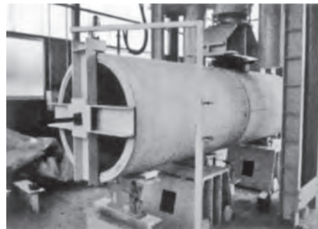
写真4-5 せん断試験状況
